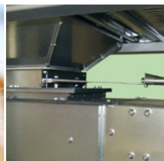
Задвижка для центральной/промежуточной заслонки с регулировочным рычагом.
